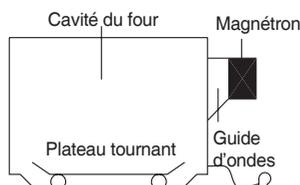
Dans un four à micro-ondes, l'électricité est convertie en micro-ondes par le MAGNETRON.
