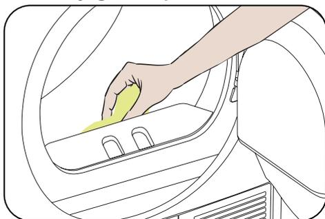
À l'intérieur de la machine se trouvent des capteurs d'humidité qui détectent si le linge est sec ou non.
